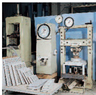
Prova di carico su un coperchio
